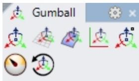
Cuando la **Orientación de Gumball** está definida como **Alinear a objeto**, el eje azul se orienta hacia la normal de la superficie de un punto de control seleccionado. Al arrastrar la flecha azul, el punto de control se mueve en la dirección de la normal de la superficie local. El eje rojo se alinea con la dirección U de la superficie. Para realizar ajustes precisos, configure la intensidad de arrastre del Gumball a un valor ligeramente inferior al 100%.
