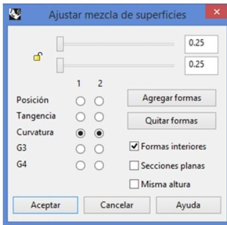
Los perfiles de las secciones transversales de cada extremo de la mezcla, así como los que añada en medio, se actualizarán para previsualizar la tangencia. Observe que la superficie no tiene pinzamientos en el medio.
