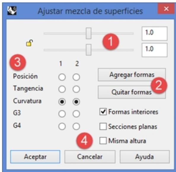
1. Los controles deslizantes se refieren a las dos curvas de forma predeterminadas de los extremos de la mezcla. Haga clic en el icono de bloqueo para que ambos lados de la mezcla se ajusten al mismo tiempo.
