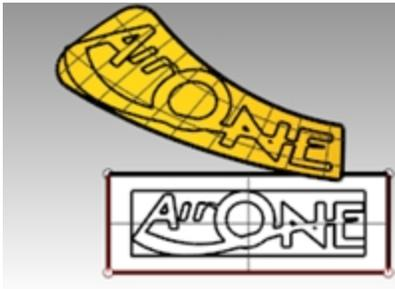
4. Ejecute el comando **CambiarGrado** (*Menú: Edición > Cambiar grado*) para cambiar la superficie base al **grado 3** en ambas direcciones **U** y **V**.
