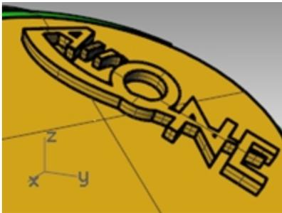
El texto es ahora una polisuperficie cerrada. Sin embargo, en esta extrusión no hay un ángulo de desmoldeo que ayude en la extracción del molde. A continuación, ejecute el comando **Deshacer** y vuelva a extruir con la opción de ángulo de desmoldeo.
