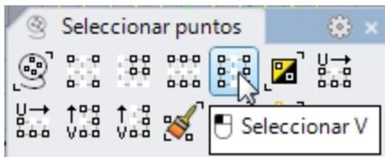
Se seleccionará una fila de puntos en la otra dirección del rectángulo. Esta disposición en las direcciones U y V siempre se da en superficies NURBS.
