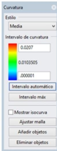
Se creará una visualización de color falso que utiliza el mismo tipo de mallas de análisis que el comando **Cebra**. La cantidad de curvatura se mapea en una gama de colores que permite analizar las áreas con cambios abruptos de curvatura o puntos planos.
