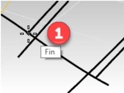
4. Para el punto Final, designe donde la curva exterior del otro lado se interseca con la curva previamente seleccionada. Designe el punto con la referencia a objetos Int o Fin donde las curvas de carril tocan la línea proyectada para acortar la curva.
