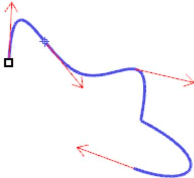
La commande **Direction** permet aussi d'afficher les directions u, v et normale des surfaces. Les normales de la surface sont représentées par des flèches perpendiculaires à la surface et les directions u et v sont indiquées par deux flèches qui reposent sur la surface. Les normales des surfaces fermées sont toujours orientées vers l'extérieur.
