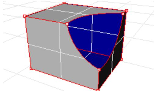
Même si une polysurface semble fermée, il se peut que la commande **Propriétés** indique qu'elle est ouverte. Certaines opérations et procédures d'exportation nécessitent des polysurfaces fermées. De plus, la qualité d'un modèle composé de polysurfaces fermées est normalement plus grande que celle d'un modèle présentant des petites ouvertures et fissures.
