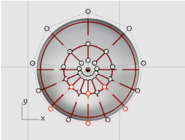
Utilisez des sélections par fenêtre et par recouvrement pour sélectionner les points de contrôle sur la partie inférieure et supérieure de l'ellipsoïde.
