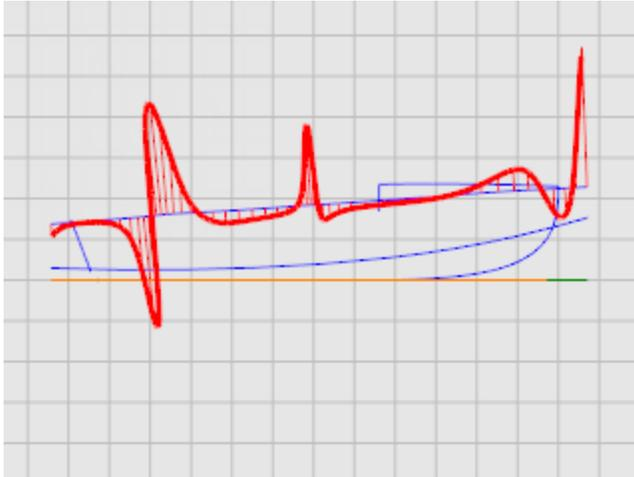
Le diagramme de courbure devrait être continu et montrer les caractéristiques désirées de la courbe. Quand la courbe est concave vers le bas, le diagramme sera situé au-dessus de la courbe. Inversement, le diagramme des courbes concaves vers le haut passera en dessous. Le point d'inflexion (où la courbe n'est concave ni vers le haut ni vers le bas) est le point où le diagramme traverse la courbe.
