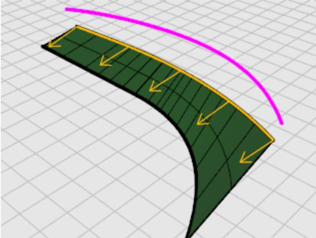
3. Dans la boîte de dialogue **Options de surface par sections**, sous **Courbes de section transversale**, sélectionnez **Reconstruire avec...** et indiquez **15** pour le nombre de points de contrôle puis cliquez sur **Accepter**.
