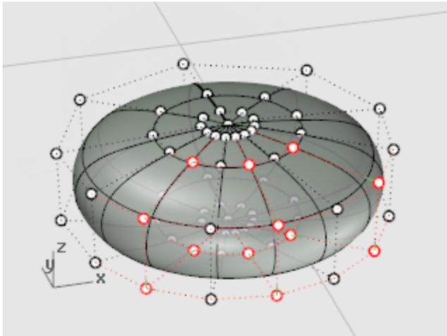
2. Utilisez la commande **Échelle2D** pour changer l'échelle des points de contrôle et éloigner les points du centre du pied.
