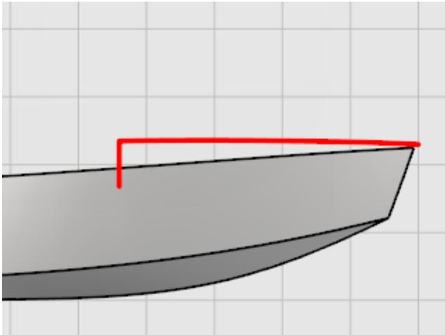
Utilisez la commande **Projeter** pour projeter la ligne verticale sur le côté de la coque. Cette ligne servira de repère pour l'extrémité de la courbe. Dans la fenêtre **Face**, dessinez une courbe allant de la fin de l'axe du pont à la fin de la courbe projetée sur un côté de la coque. Utilisez le mode **Planéité** pour que la courbe reste sur le même plan. Placez les trois premiers points de contrôle en utilisant le mode **Ortho** afin qu'ils soient alignés au centre.
