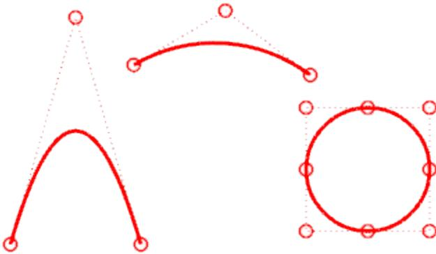
Une courbe de degré 3 doit avoir au moins quatre points de contrôle.
