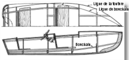
Les lignes de départ sont montrées ici. La tonture et le bouchain ont été prolongés sur les deux extrémités longitudinales afin de faciliter la création de la surface par sections.
