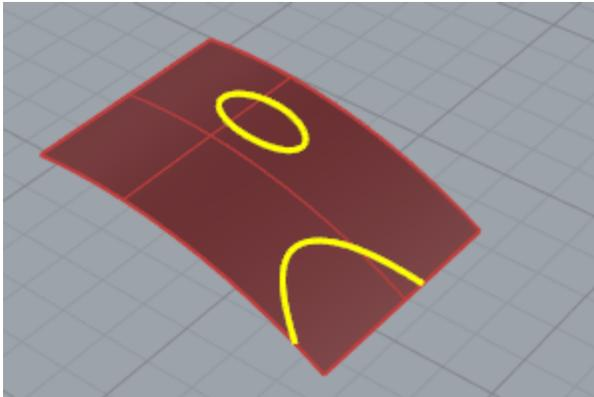
Lorsqu'une courbe limite traverse une surface en diagonale elle n'a aucune relation réelle avec la structure des points de contrôle de la surface. Vous pouvez le voir si vous sélectionnez une surface limitée de ce type et activez ses points de contrôle. Vous verrez les points de contrôle de toute la surface sous-jacente.
