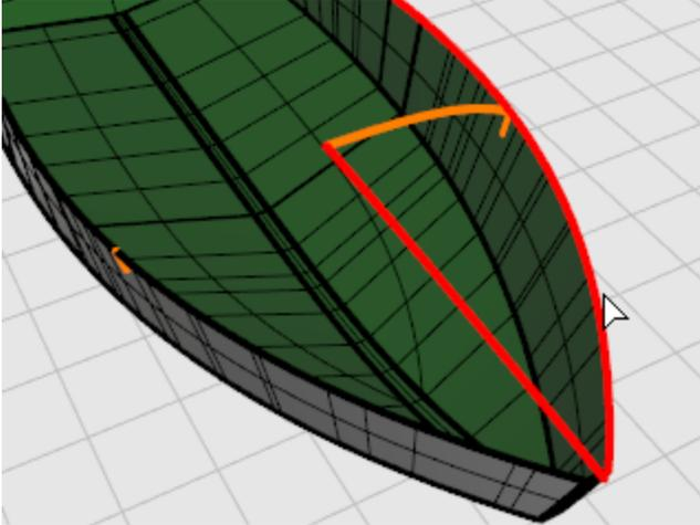
3. À l'invite **Sélectionner les courbes de section transversale...**, sélectionnez la courbe de section transversale que vous avez créée entre l'axe décalé et la courbe projetée sur la coque puis appuyez sur **Entrée**.
