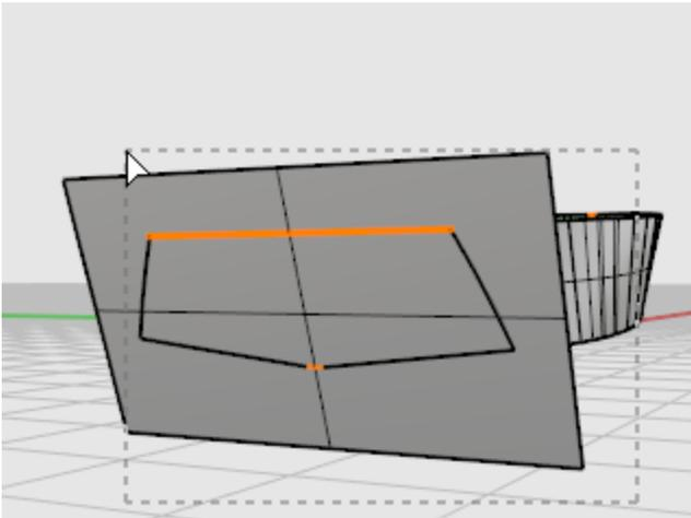
4. À l'invite **Sélectionner l'objet à limiter...**, sélectionnez la surface du tableau arrière en dehors des lignes et surfaces de la coque et appuyez sur **Entrée**.
