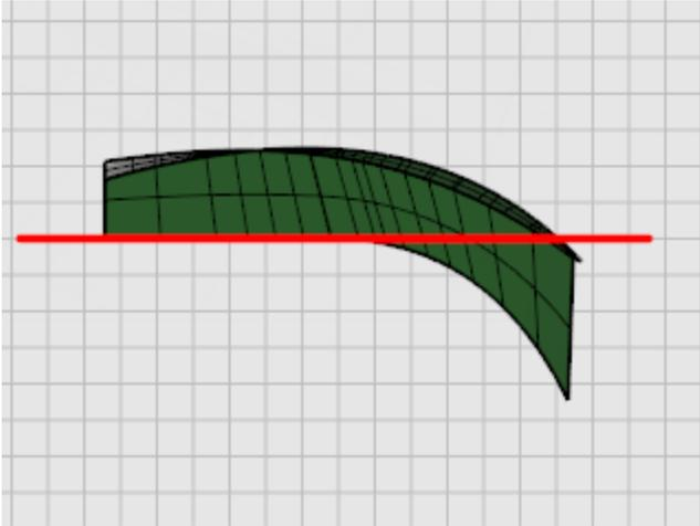
2. Dans la fenêtre **Dessus**, décalez la ligne d'un demi pouce vers les surfaces de la coque.
