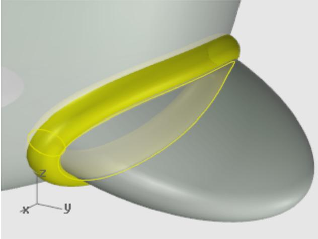
3. À l'invite **Sélectionner l'objet à limiter**, sélectionnez le corps et la queue et appuyez sur **Entrée**.
