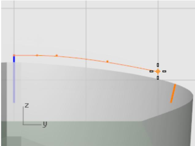
Utilisez l'accrochage **Fin** pour placer le dernier point sur la partie supérieure de la courbe projetée sur la coque.
