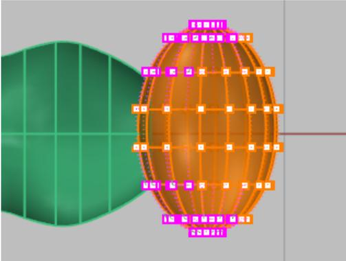
2. Dans la fenêtre **Dessus**, sélectionnez les points de contrôle des deux côtés de l'ellipsoïde (avant et arrière) pour déformer la tête.
