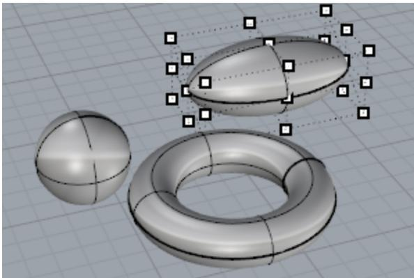
Certaines commandes de Rhino créent des solides constitués d'une polysurface. **Pyramide**, **Cône** et **CôneT** sont des exemples de commandes qui créent des solides composés d'une polysurface.
