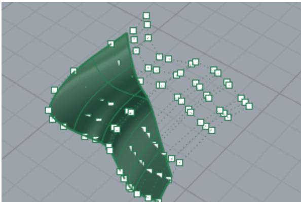
Si vous créez une surface à partir d'une courbe plane, il peut s'agir d'une surface limitée. La surface suivante a été créée à partir d'un cercle. L'affichage des points de contrôle montre la structure rectangulaire de la surface.
