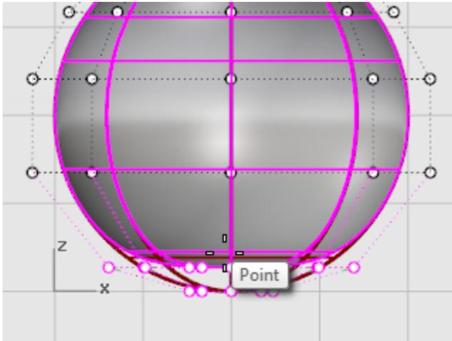
Ceci vous permettra d'aligner tous les points de contrôle sélectionnés à la même valeur z (en haut dans la fenêtre **Face**) et d'aplatir la surface.
