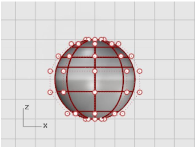
Repositionnez les points de contrôle pour créer la rainure du cou et pour corriger la forme du corps.
