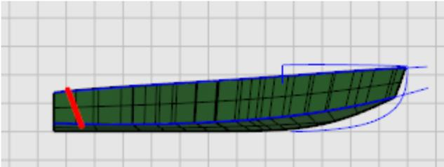
4. À l'invite **Fin du prolongement**, sélectionnez un point au-dessus de la partie supérieure de l'axe du tableau arrière.
