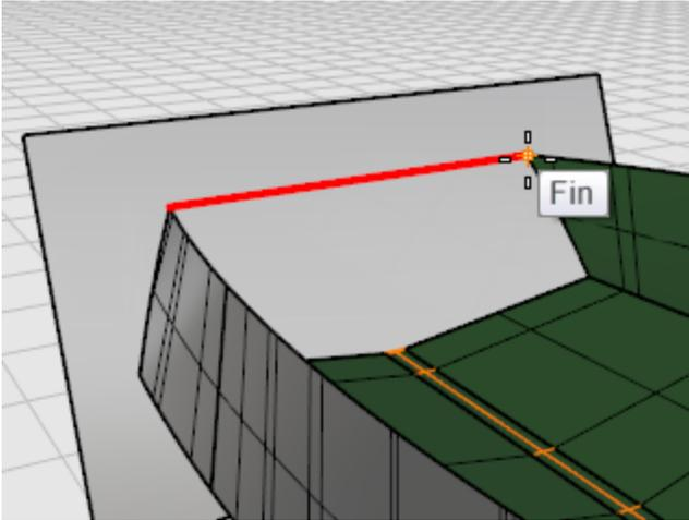
3. À l'invite **Sélectionner les objets coupants**, sélectionnez toutes les surfaces de la coque, y compris la surface de la quille et la ligne supérieure de la coque et appuyez sur **Entrée**.
