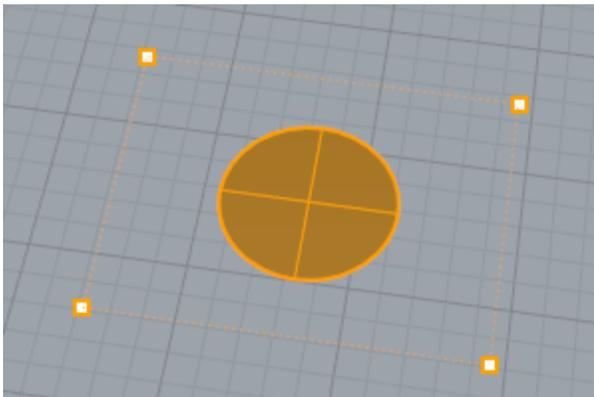
La commande **AnnulerLimite** supprime la courbe limite de la surface pour récupérer la surface rectangulaire non limitée sous-jacente.
