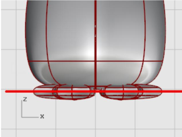
La commande **PlanCoupe** crée un plan qui passe au travers des surfaces sélectionnées le long de la ligne que vous dessinez.
