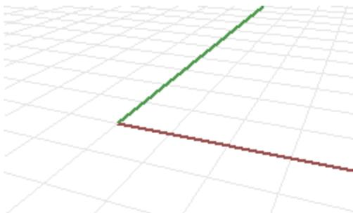
Le plan de construction de chaque fenêtre de Rhino est, par défaut, celui correspondant à la vue. Cependant, la fenêtre **Perspective** utilise le plan de construction de la vue de dessus du repère général, c'est-à-dire le même plan de construction que celui de la fenêtre Dessus.
