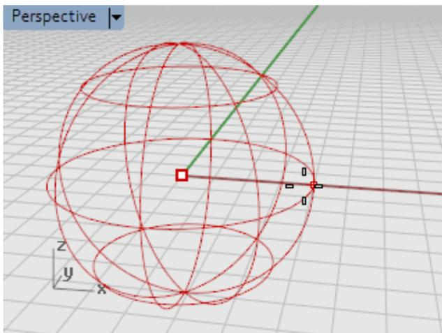
3. Dans la fenêtre **Perspective**, cliquez sur la petite flèche à droite du **titre de la fenêtre**, et dans le menu, cliquez sur **Ombré**.
